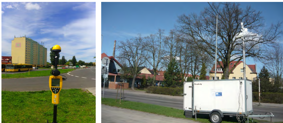
Fotografia 7.4. Pomiary PEM i hałasu komunikacyjnego z wykorzystaniem mobilnej stacji (źródło: WIOŚ w Szczecinie)
